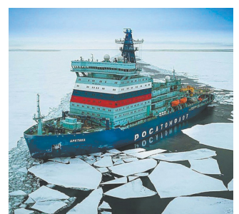
Универсальный атомный ледокол проекта 22220 типа «Арктика»
