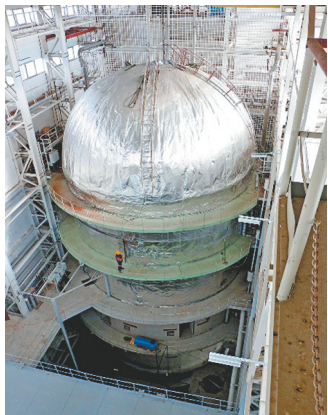
КМС — крупномасштабная модель защитной оболочки АЭС с ВВЭР
