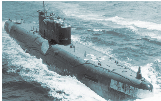
Дизель-электрическая подводная лодка с вспомогательной ЯЭУ ВАУ-6
