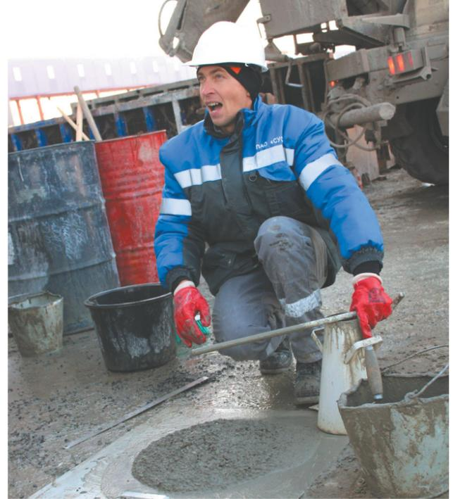
Специалисты лаборатории проверяют бетон в каждом миксере на соответствие технологическим требованиям
