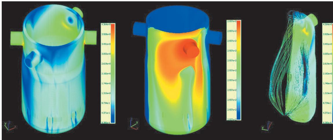
Результаты численного моделирования теплогидравлических процессов в реакторных установках АЭС с использованием расчётного кода КОРСАР
