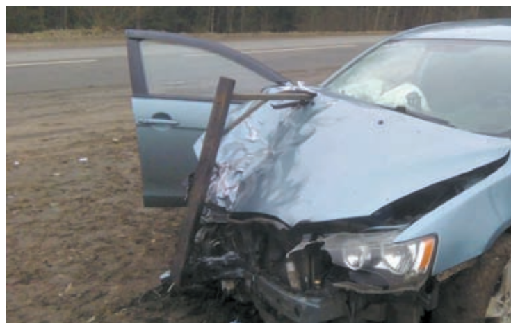
Последний случай налетевшего на ограждение автомобиля на Ленинградской закончился смертью пассажира от пробившего корпус автомобиля элементом ограды
