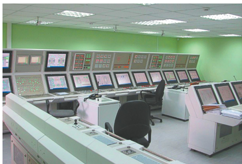
Полномасштабный тренажер для ПАТЭС на базе ПЭБ проекта 20870
